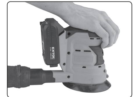
Abb. 5, Führen der Schleifmaschine mit der Hand über die geschliffene Oberfläche
