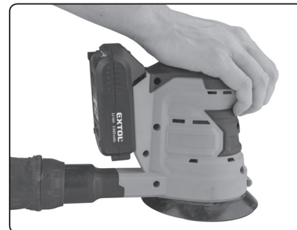
Obr. 5, vedenie brúsky po brúsenom povrchu rukou
