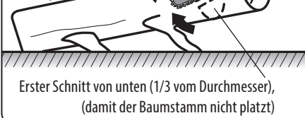
Baumstamm an einem Ende abgestützt, Abb. 14
