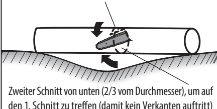
Baumstamm an beiden Enden abgestützt, Abb. 15
