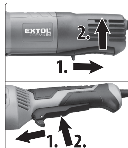
Obr.15; krok 1. odjištění, krok 2. zapnutí
