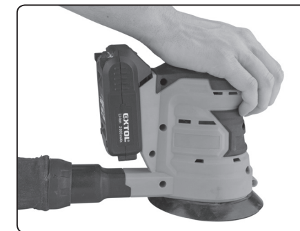
Obr. 5, vedenie brúsky po brúsenom povrchu rukou
