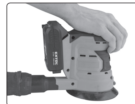
Obr. 5, vedení brusky po broušeném povrchu rukou
